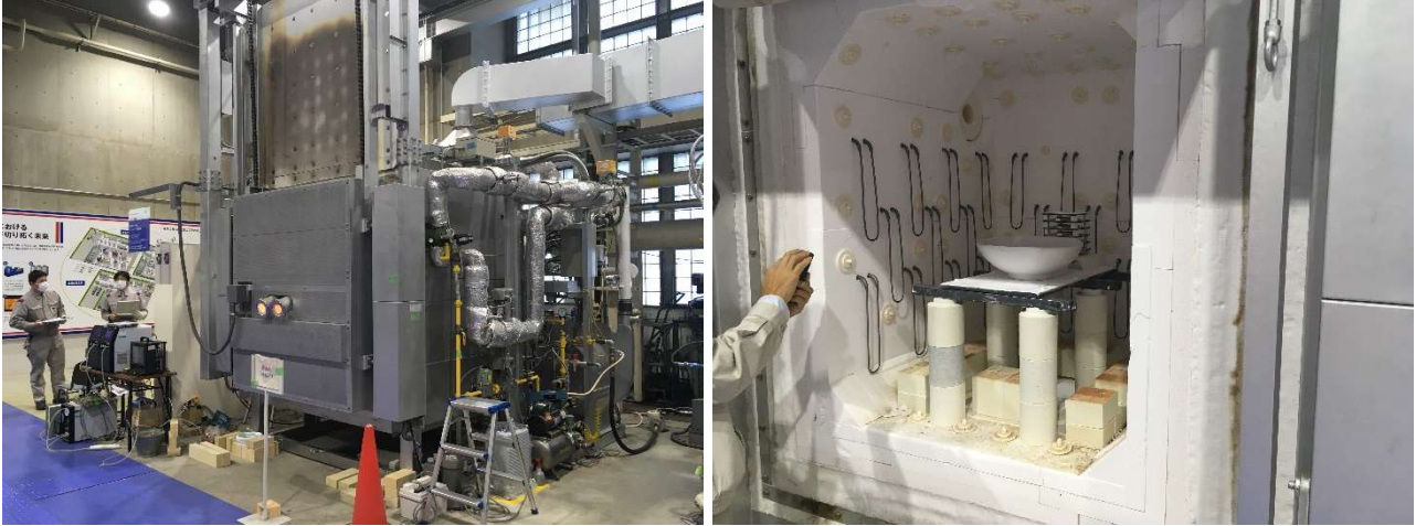
(写真) 東京ガス試験場でのセラミック焼成における水素燃焼試験の様子
