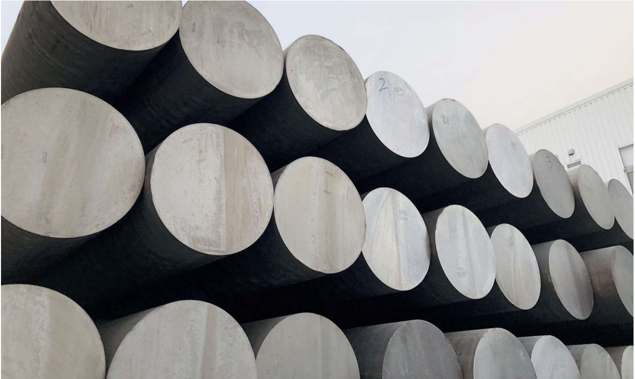
（写真）リサイクルアルミを使用し鑄造したビレット
