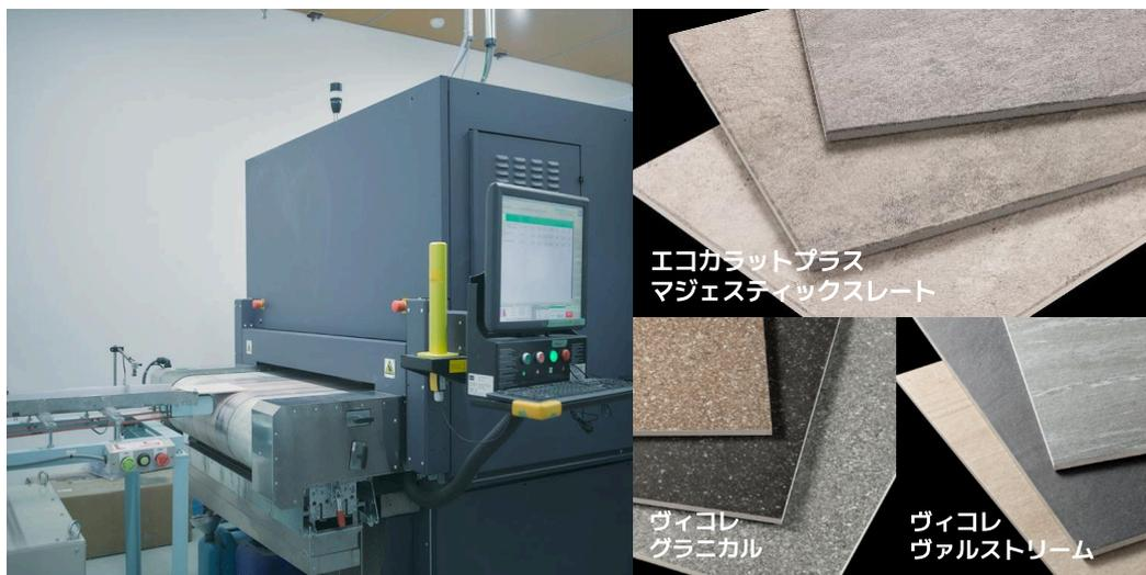
凸凹のついたローラーでタイルに釉薬を転写し、柄を付ける従来の方式に比べ、「インクジェット加飾」は1つの機械で多彩な色や柄を付けられることを最大の特長としています。また、狙った場所にピンポイントで加飾を施すため、釉薬の種類・量の削減が可能です。生産品種の切り替え時に釉薬の入れ替えが発生しない「インクジェット加飾」を用いることによって、釉薬のロスが10%改善されました。また、釉薬の入れ替えが不要なため、洗浄に使用する水量が削減でき、インクジェット設備導入前と比較すると、水使用量を18%削減できました。さらに、品種切り替えや焼き物特有の色合わせなどの作業工数を減らせることで、ライン全体の効率が向上し、6%のCO<sub>2</sub>排出量削減<sup>\*</sup>にも寄与しています。
