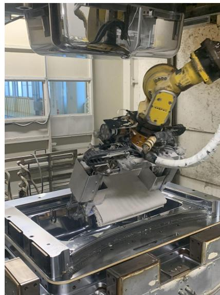
定位置へ材料を投入する工程の自動化には治具改善、AI判定を繰り返し微調整し、自動化には1年を要した。
