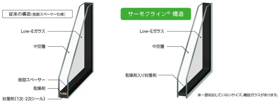
高性能窓「TW」のサーモクラインは、内部結露・ガスリークに強い長寿命設計で従来よりも耐久性が5倍<sup>※4</sup>。サーモクライン構造は熱を伝えにくいいため、樹脂スペーサーを使用した構造よりさらに高い防露性能を実現しています。
