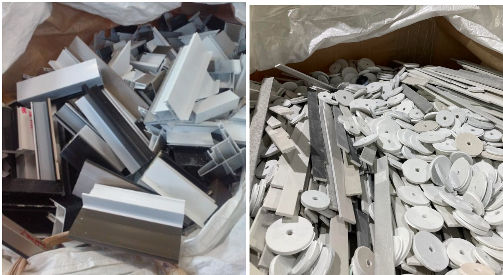
（左：樹脂窓の生産過程で出た端材、右：FRP浴槽の加工過程で出た廃FRP）
